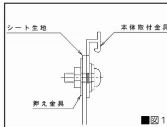
注：網戸タイプはシート生地と金具の間にクッション材を使用してください。
